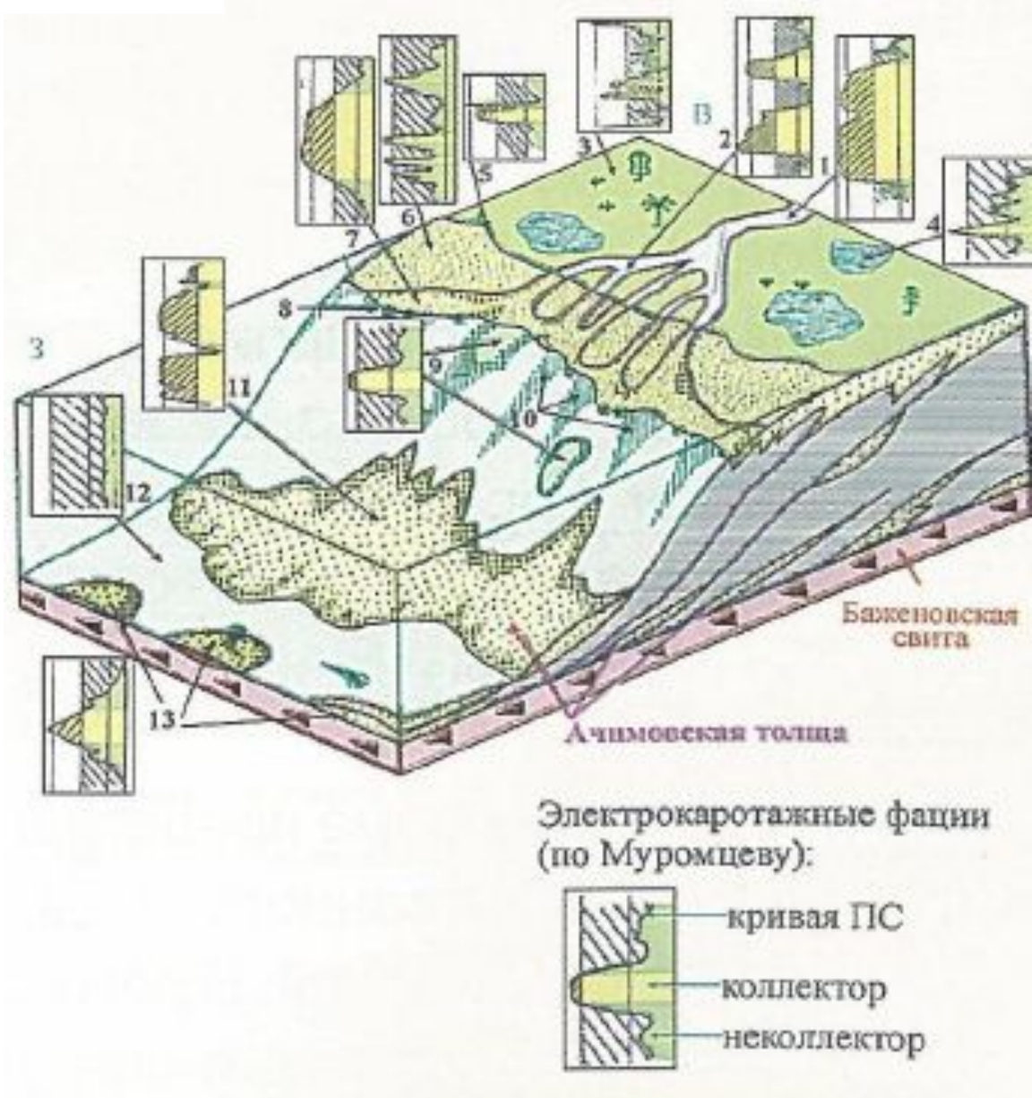
Принципиальная схема строения клиноформ неокома Западной Сибири (по А.А. Нежданову и др., 2000).
