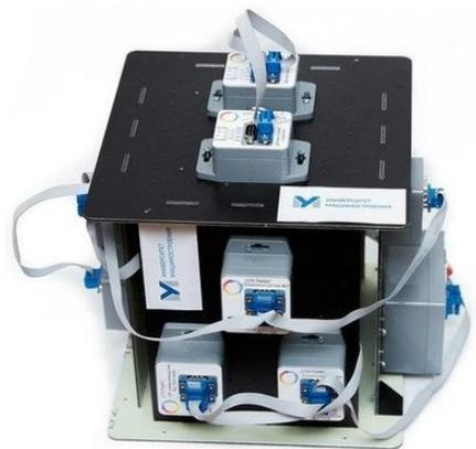
Образовательная программа «КОСМОКВАНТУМ» предполагает обучение детей конструированию космических аппаратов с использованием симулятора космических аппаратов «Орбита» и конструктора микроспутника на специальном стенде, который моделирует движение спутника по земной орбите.
