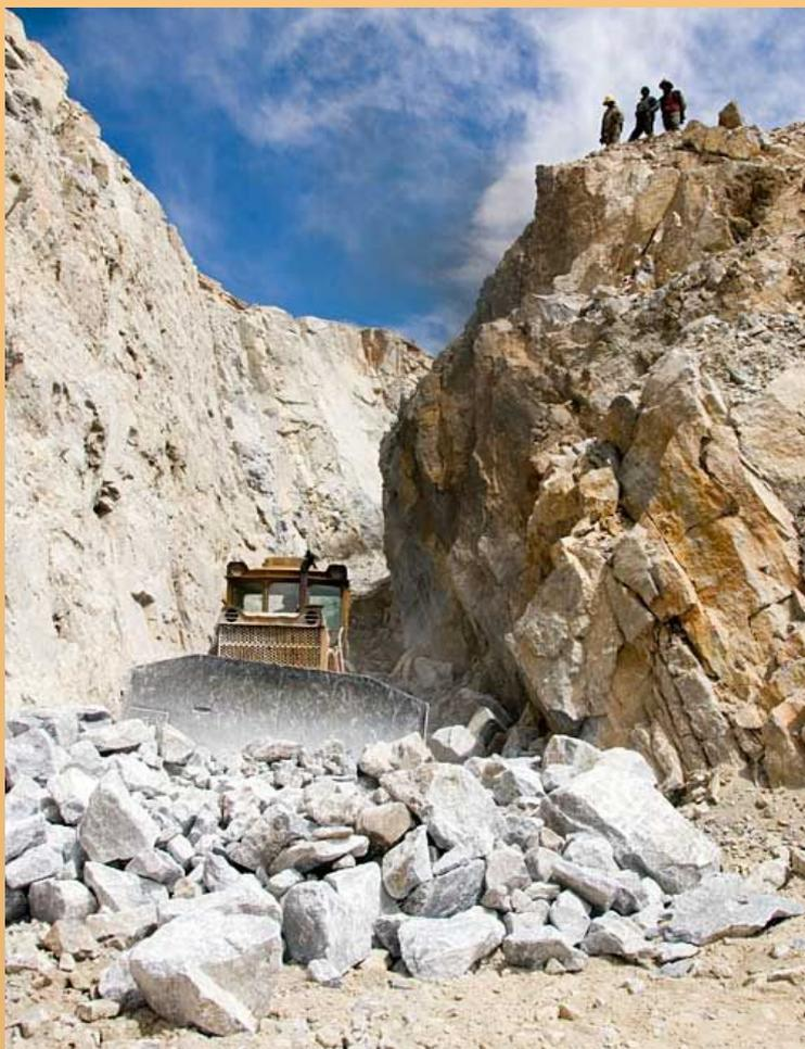
Добыча самоцветов ведется практически также, как в Афганистане: с помощью динамита и бульдозеров. Разработка элювиальных отложений в долине ниже отложений мраморов затруднена из-за отсутствия постоянных водных потоков.
