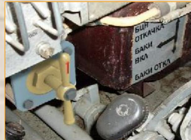
Положения рукоятки крана указаны на табличке, прикрепленной к левому носовому баку впереди крана.
