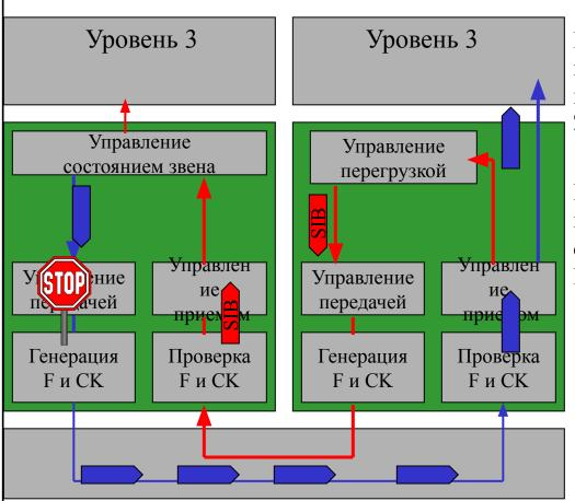
В случае невозможности передачи MSU на уровень 3 функция управления перегрузкой выдает LSSU «Индикация Занятости» (SIB - Status Indicator "Busy")
