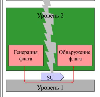
Передающая сторона использует специальный алгоритм для вычисления Проверочных Бит (Check Bits - CK) из содержимого сигнальной единицы
