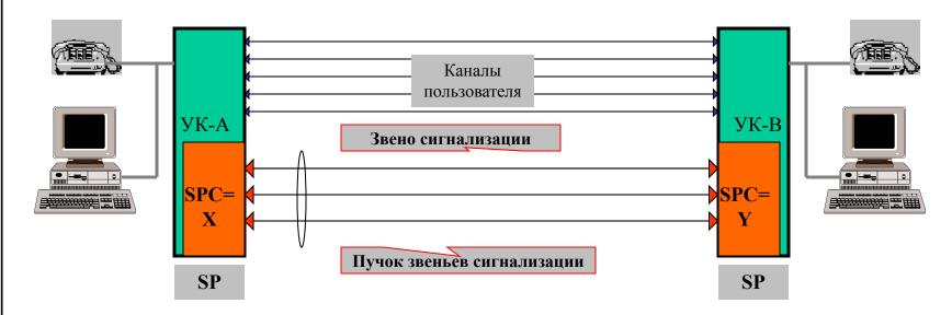
Группа звеньев сигнализации между между двумя смежными пунктами сигнализации образуют *Пучок Звеньев Сигнализации* (LS, Link Set)
