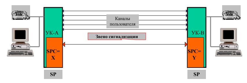
Узел коммутации с функциями ОКС№7, в терминах сети ОКС№7, называется Пунктом Сигнализации (SP, Signalling Point). Различают SP и STP
