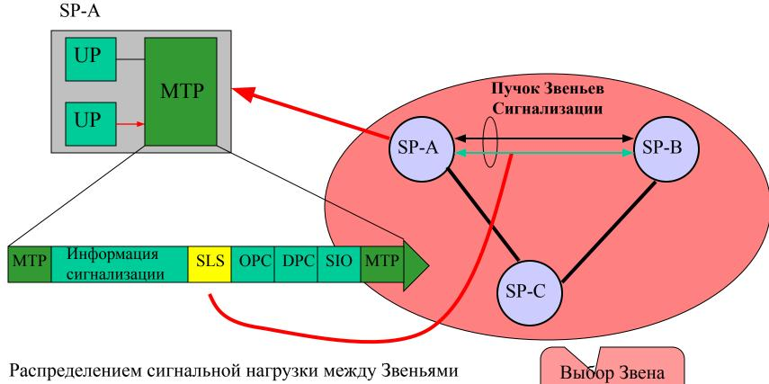
Сигнализации происходит с помощью поля Выбор Звена Сигнализации (Signalling Link Selection - SLS).
