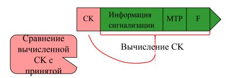
Принимающая сторона, используя тот же алгоритм, вычисляет СК и сравнивает полученный результат с СК, принятой сигнальной единицы
