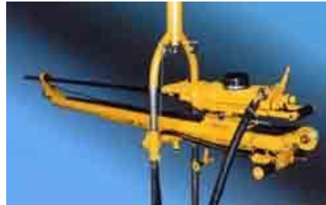
Перфоратор ПП80НВ на установке УПБ-1
