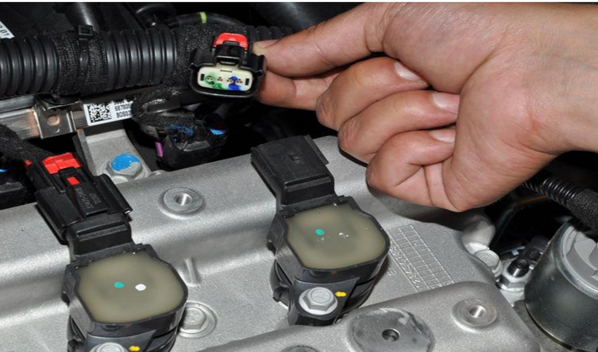
Еще раз повторим как работает - микропроцессорная система зажигания. Датчик положения коленвала, подает импульс ЭБУ, когда поршень в цилиндре двигателя находится в конце такта сжатия, ЭБУ меняет напряжение
