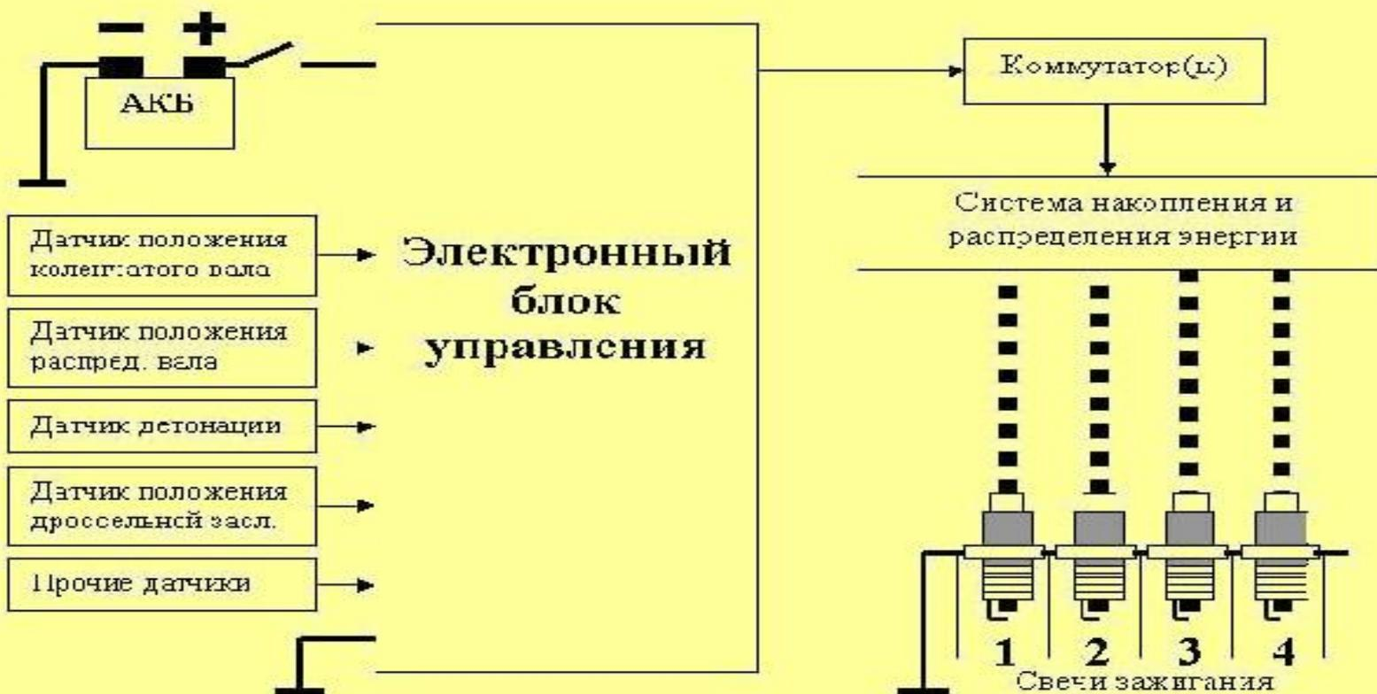
Из чего состоит - микропроцессорная система зажигания? АКБ, замок зажигания, датчик положения коленчатого вала, ЭБУ (или ТК транзисторный коммутатор), свечи зажигания, КАТУШКИ ЗАЖИГАНИЯ НА КАЖДЮЮ СВЕЧУ ЗАЖИГАНИЯ
