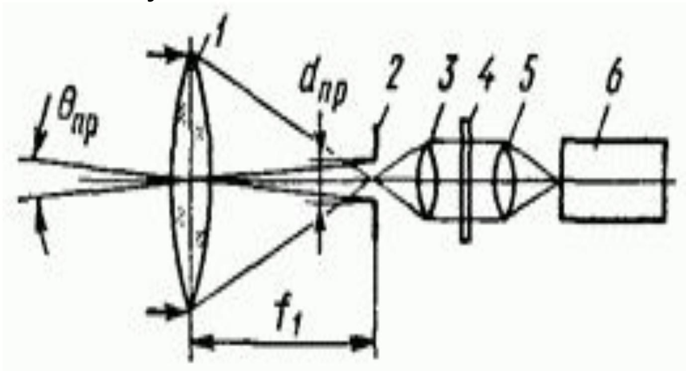
Принимаемый световой пучок поступает на объектив 1, в фокусе которого располагается диафрагма 2, вместе с объективом определяющая поле зрения ОПУ:
