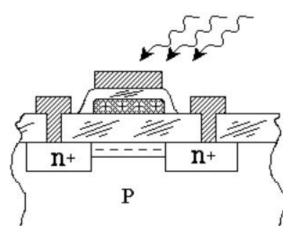
Ячейка представляет собой МОП транзистор, в котором затвор выполняется из поликристаллического кремния. Затем в процессе изготовления микросхемы этот затвор окисляется и в результате он будет окружен оксидом кремния — диэлектриком с прекрасными изолирующими свойствами.
