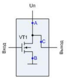
На рисунке представлена простейшая схема реализации инвертера, состоящая из одного транзистора. Рассмотрим, как он работает.
