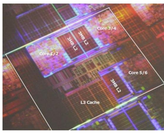
Рассмотрим пример организации многоуровневой кэш памяти в процессорах с микроархитектурой Intel Core. Все современные процессоры Intel основаны на базе микроархитектуры Intel Core (которая в плане кэша не отличается от микроархитектуры Nehalem) и имеют трехуровневую подсистему кэшпамяти. Кэшпамять первого уровня L1 делится на 8-канальный 32-
