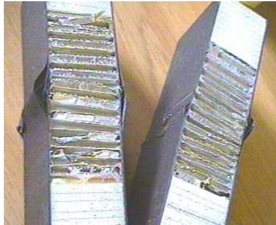
Образцы с углепластиковыми обшивками и сотовым наполнителем из фольги после испытаний до разрушения
