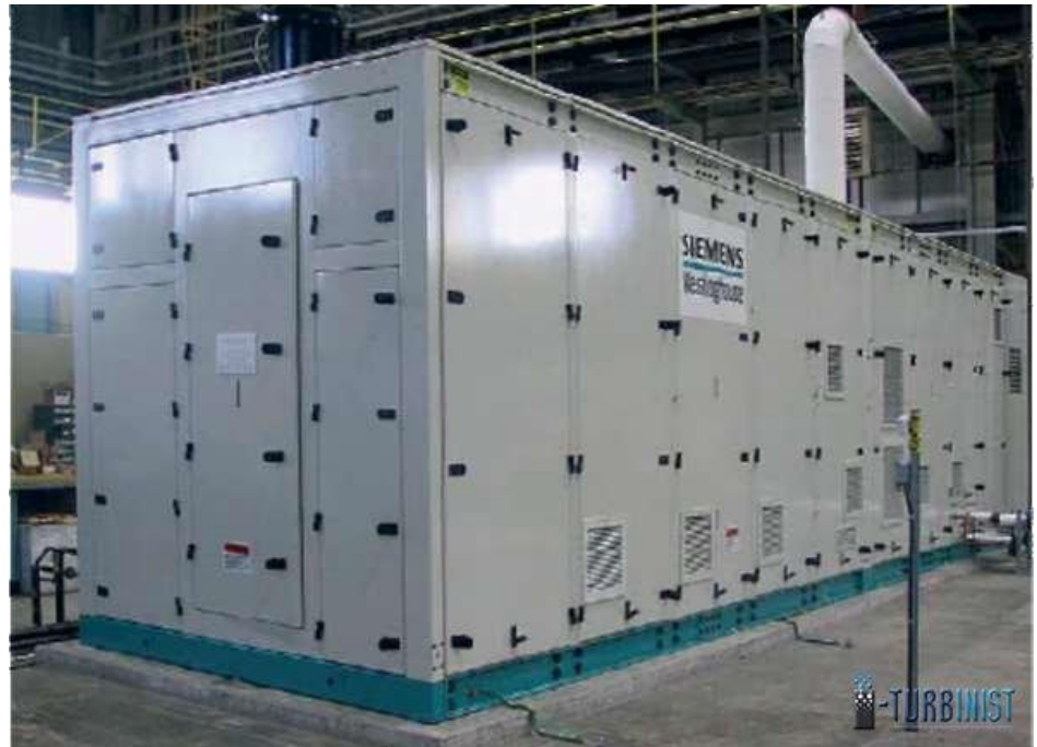
Энергетическая установка Siemens на базе твердооксидных топливных элементов
