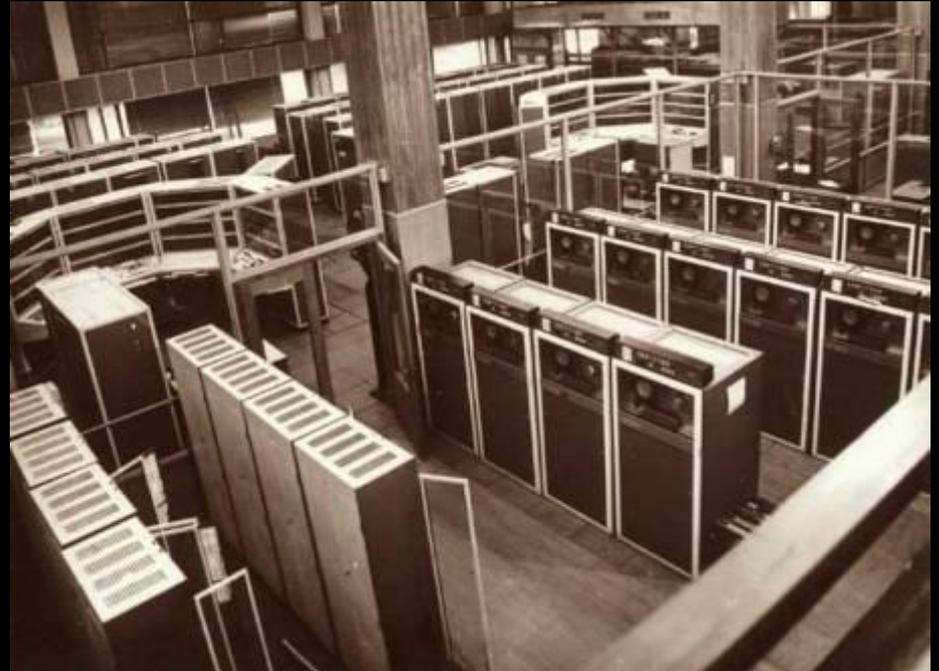
Основной составляющей таких ЭВМ была электронная вакуумная радиолампа в количестве нескольких тысяч. У лампы был относительно не большой срок службы от 500 до 4000 часов непрерывной работы.
