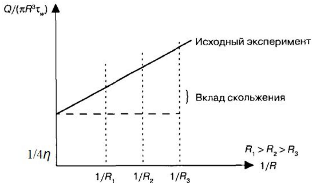
**Рис. 2.82.** Зависимость приведенного расхода от обратного радиуса капилляра для оценки поправки Муни при скольжении расплава по стенке
