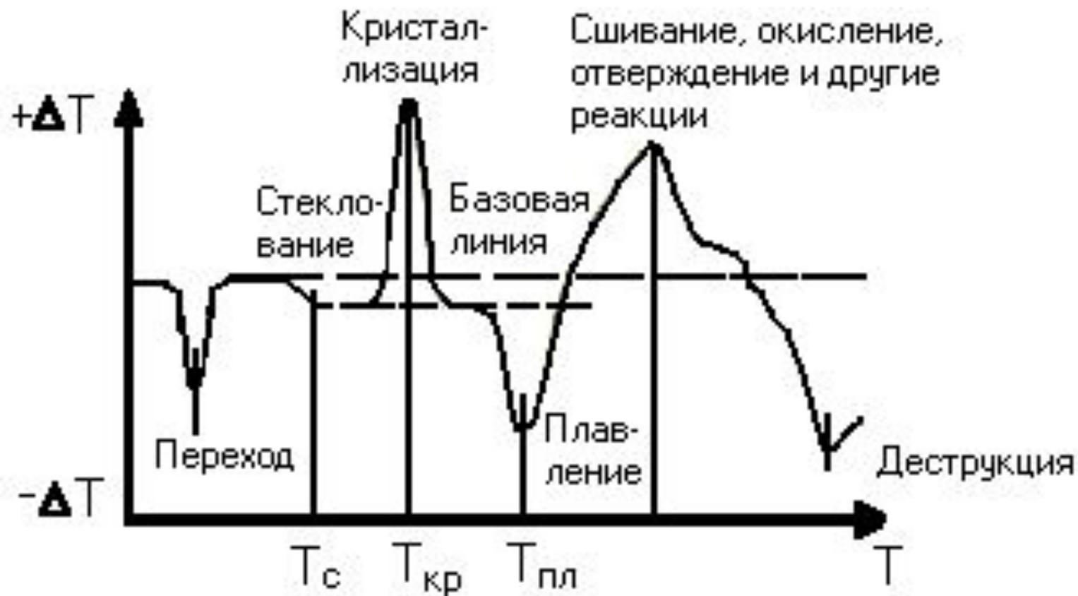
Рис.2 - Схематическая кривая ДТА полимера
