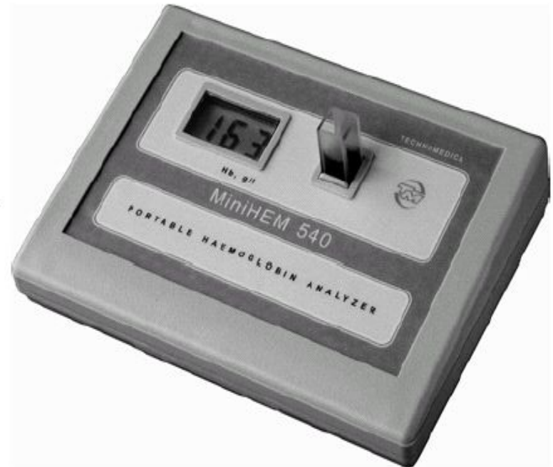
Рис. 122. Гемоглобинометр МиниГЕМ - оптическая схема и внешний вид.
