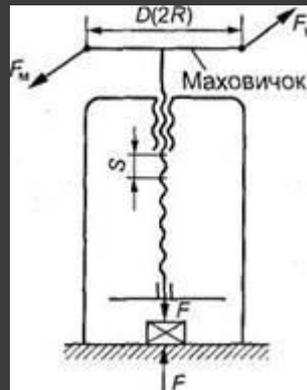
Рис. 24. Кинематическая схема передачи винт-гайка
