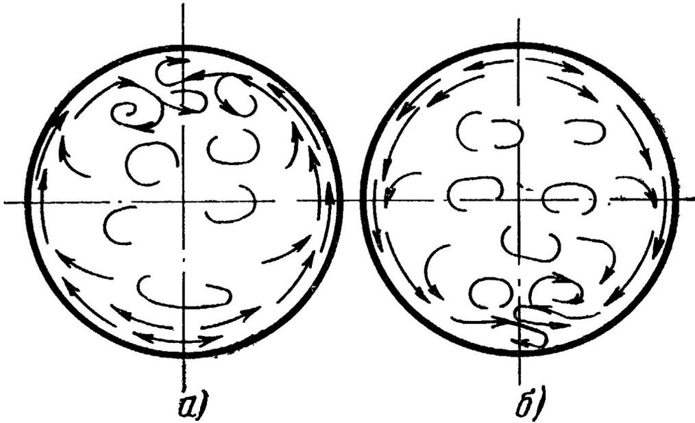
Поперечная циркуляция в горизонтальной трубе вследствие наличия свободного движения жидкости: *а* – при нагревании жидкости; *б* – при охлаждении жидкости.
