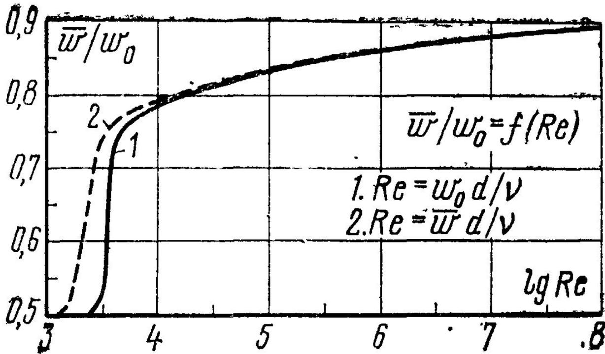
Приведённые законы распределения скоростей по сечению трубы справедливы лишь для так называемого *гидродинамически стабилизированного движения*.
