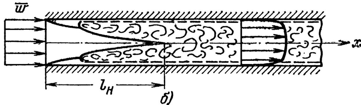
Гидродинамическая стабилизация течения жидкости в трубе.
