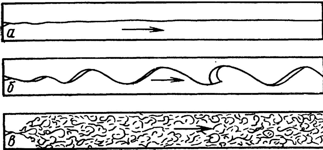
Режим течения жидкости определяется **числом Рейнольдса**.
