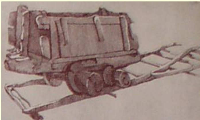
Вагонетка («собака») на рельсовом деревянном пути.
