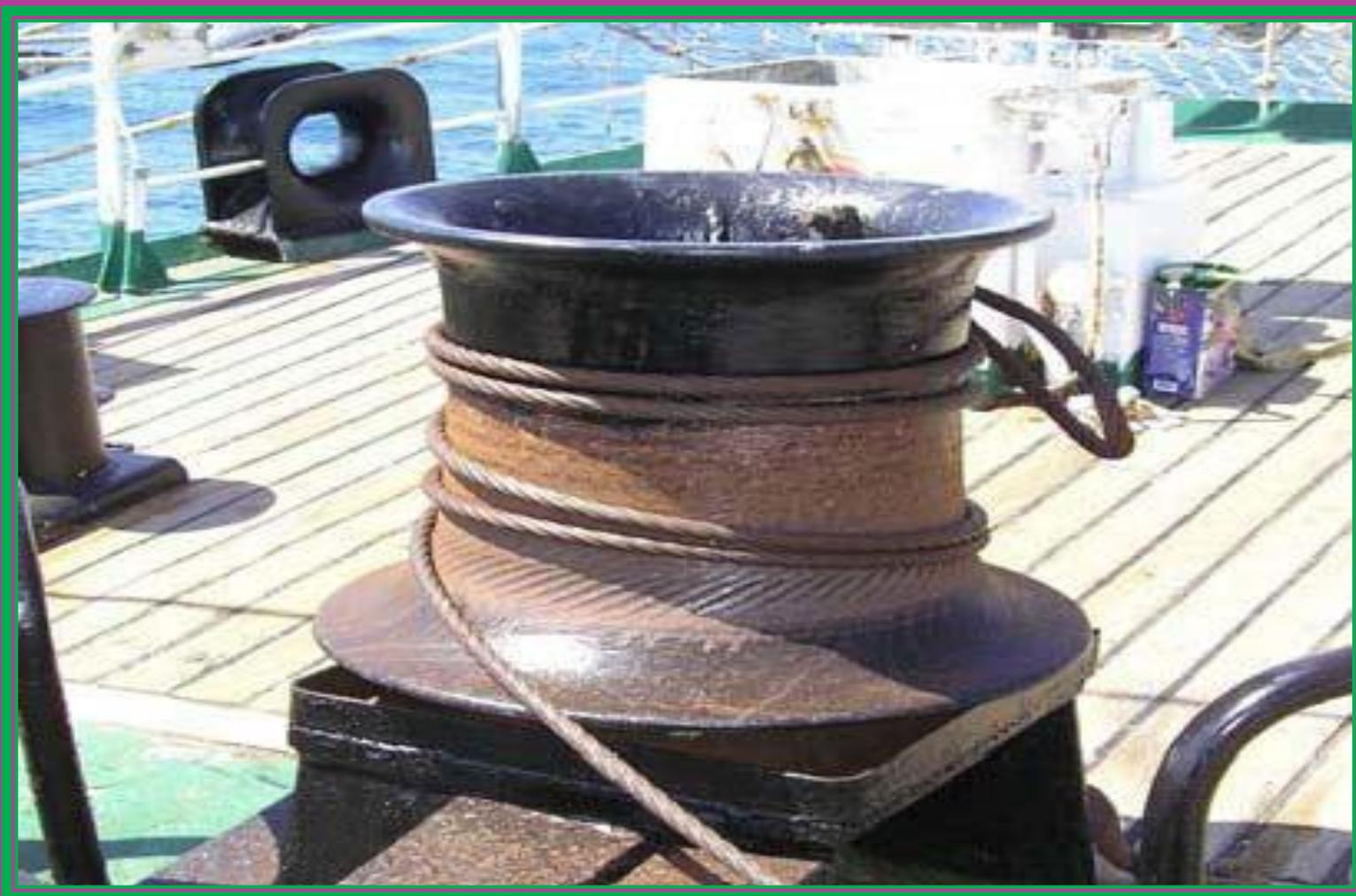
***Швартовые шпиги устанавливаются для работы с кормовыми швартовыми.***
