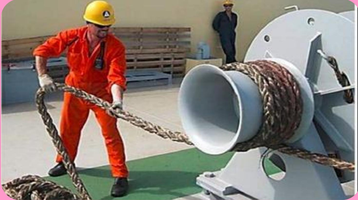
**Брашпиль – предназначен для выбирания швартовов на баке. Для этих целей используют турочки брашпиля, расположенные на концах**
