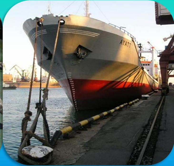
**Швартов – трос (канат) с огоном на конце, который надевают на береговую тумбу, а второй конец крепят на кнехте судна.**
