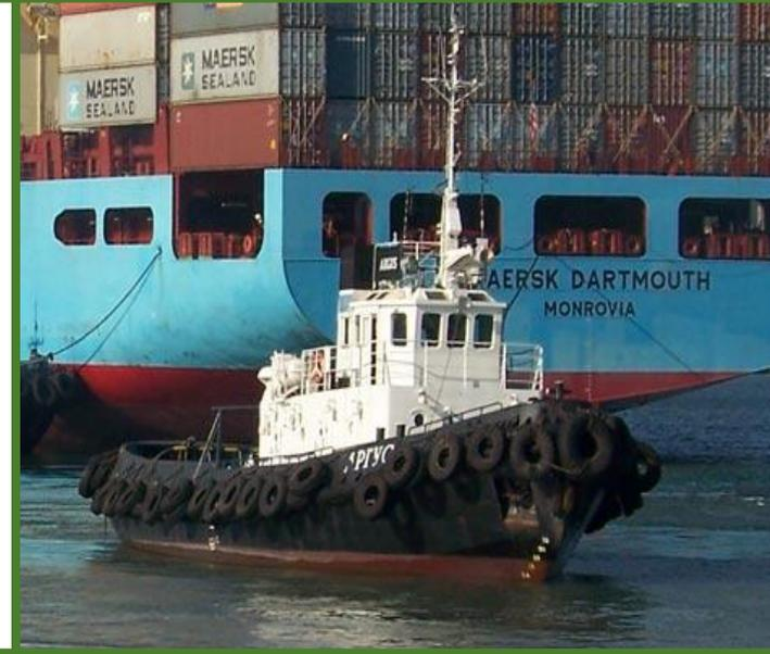
*Кранцевое устройство (привальные брусья и кранцы) - мягкие или деревянные подушки, вываливаемые за борт или закрепленные постоянно на борту в местах, наиболее подверженных ударам.*
