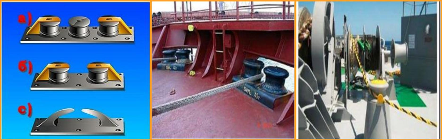
**Киповые планки** предназначены для изменения направления швартова. На большинстве современных судов устанавливают киповые планки из отдельно стоящих двух-трех роульсов.
