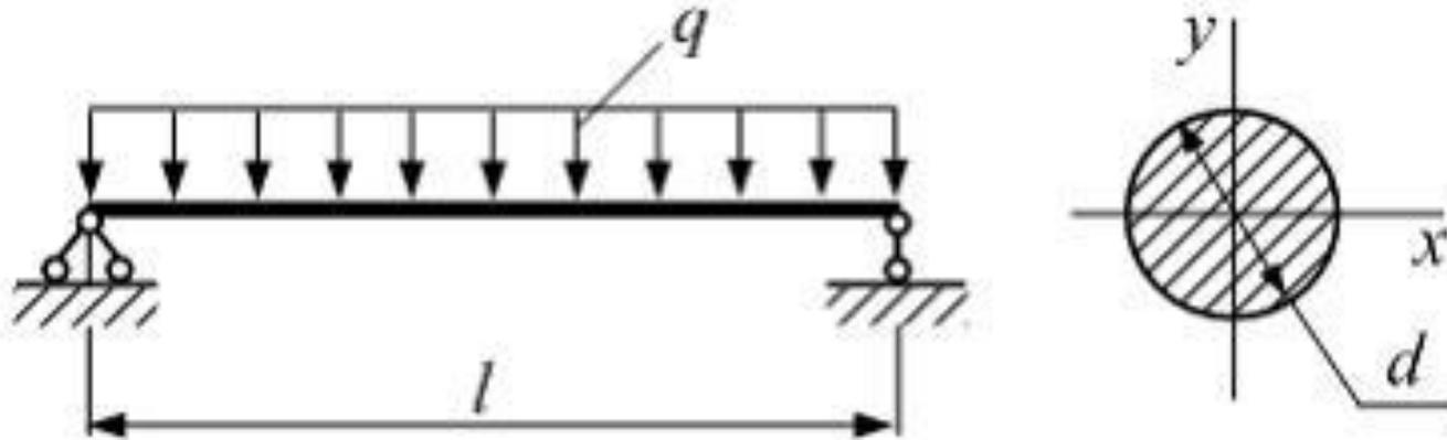
Однопролетная деревянная балка длиной  $l=6\text{м}$  нагружена равномерно распределенной нагрузкой интенсивности  $q$ . Диаметр поперечного сечения  $d=30\text{ см}$ . Значение допускаемого нормального напряжения  $10\text{ МПа}$ . Из расчета на прочность по нормальным напряжениям максимально допустимое значение интенсивности нагрузки  $q$  равно \_\_\_\_ кН/м.
