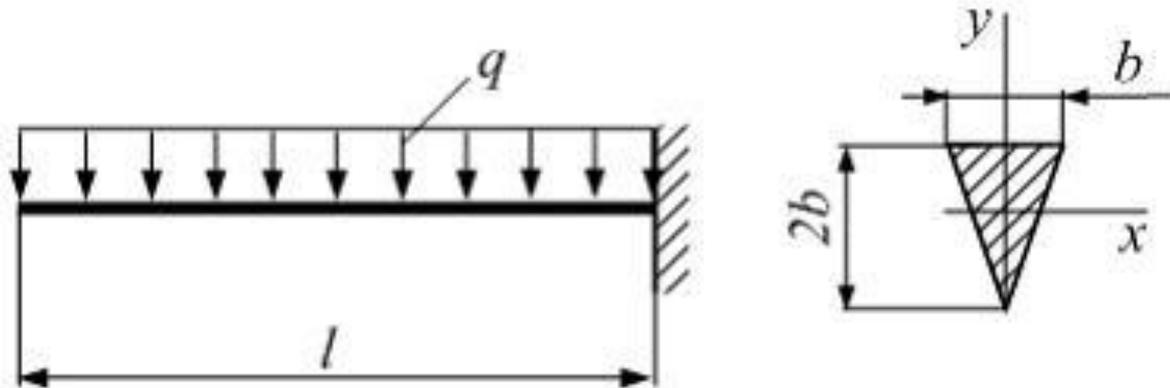
Консольная балка длиной  $l = 1,5$  м нагружена равномерно распределенной нагрузкой интенсивностью  $q = 640$  Н/м. Поперечное сечение – равнобедренный треугольник. Допускаемое нормальное напряжение для материала балки  $160$  МПа. Из расчета на прочность по нормальным напряжениям размер поперечного сечения балки  $b$  равен \_\_\_\_ (см).
