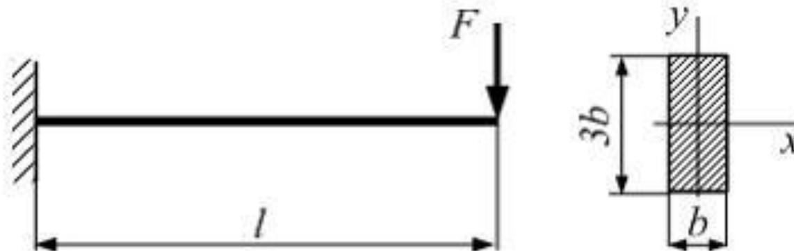
Консольная балка прямоугольного сечения нагружена силой  $F = 3 \text{ кН}$ . Допускаемое нормальное напряжение для материала балки  $160 \text{ МПа}$ , линейный размер  $b = 20 \text{ мм}$ . Наибольшая длина консоли  $l$  из расчета на прочность по нормальным напряжениям равна \_\_\_ см.
