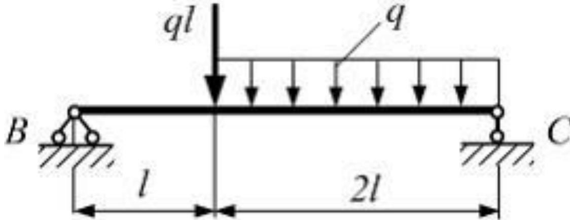
Однопролетная балка  $BC$  длиной  $3l$  нагружена силой  $ql$  и равномерно распределенной нагрузкой интенсивности  $q$ . Максимальные значения изгибающего момента и поперечной силы по абсолютной величине соответственно равны ...
