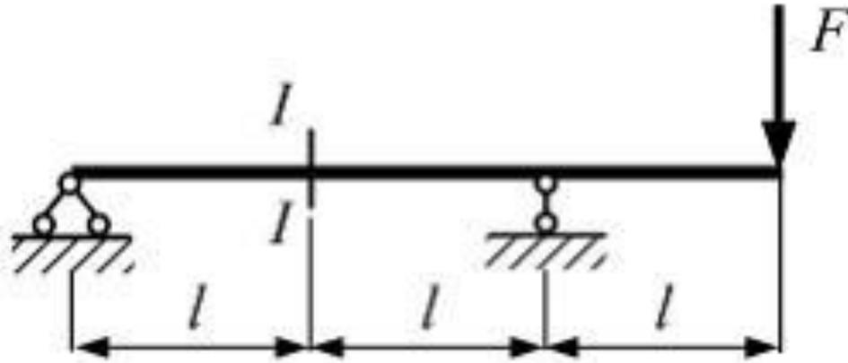
Однопролетная консольная балка нагружена силой  $F$ . Размер  $l$  задан. Значения изгибающего момента и поперечной силы по абсолютной величине в сечении I–I равны ...
