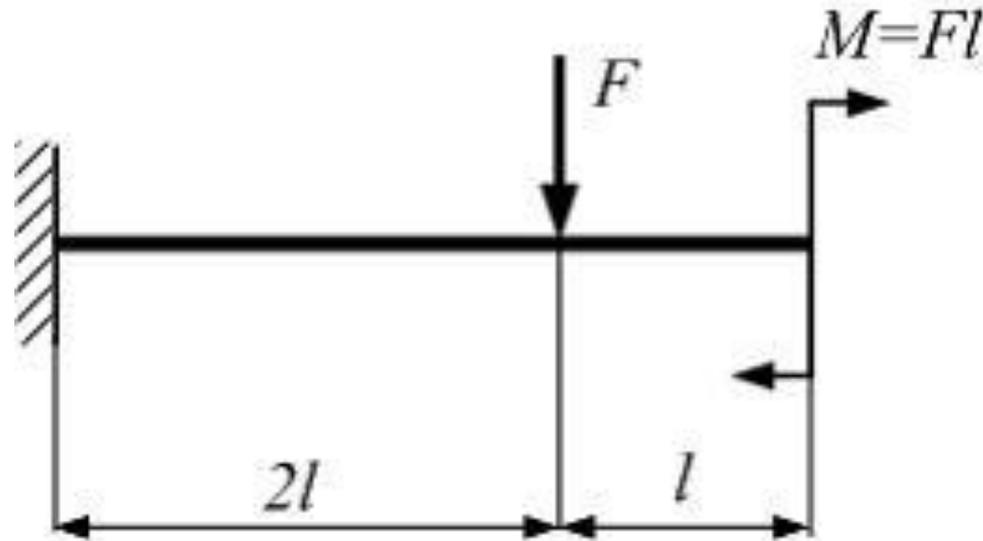
Схема нагружения консольной балки показана на рисунке. При изменении направления сосредоточенной силы  $F$  на противоположное, значение максимального (по абсолютной величине) изгибающего момента ...
