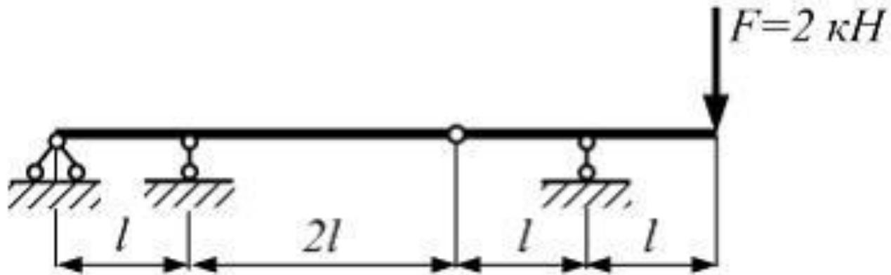
Двухпролетная консольная балка с шарниром нагружена сосредоточенной силой. Линейный размер  $l = 0,5\text{м}$ . Максимальное значение изгибающего момента в балке по абсолютной величине равно ... (кНм)
