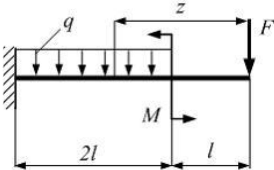
На рисунке показана схема нагружения консольной балки. Выражение изгибающего момента в сечении с координатой  $z$  имеет вид ...
