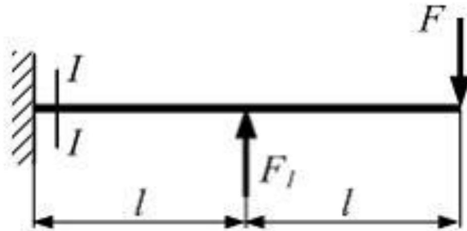
Консольная балка длиной  $2l$  нагружена силами  $F_1$  и  $F$ . Сечение I-I расположено бесконечно близко к заделке. Изгибающий момент в сечении I-I равен 0, если значение силы  $F_1$  равно...
