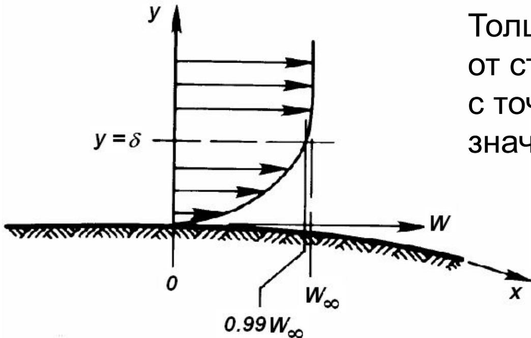
Толщина Г.П.С. - расстояние от стенки, на котором скорость с точностью до 1% достигает значения вдали от стенки
