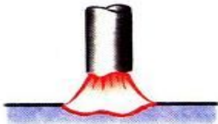
Образование прослойки из жидкого металла
