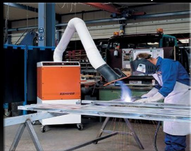
ВЫТЯЖКА СВАРОЧНЫХ ДЫМОВ
