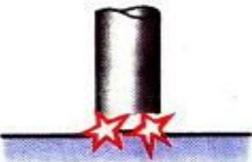
Образование прослойки из жидкого металла
