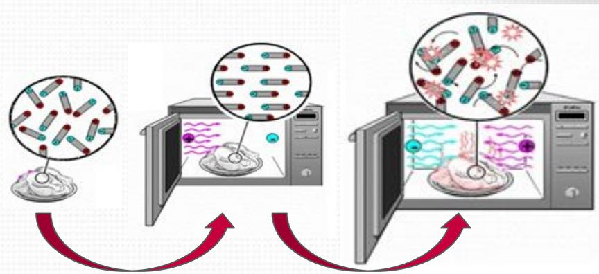
Молекулы воды (полярные), под воздействием электромагнитного поля начинают сдвигаться, раскачиваться, сталкиваться, ударяться друг о друга, передавая энергию соседним молекулам, увеличивая температуру продукта
