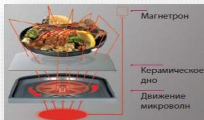
Благодаря равномерной и регулярной подаче микроволн в камеру печи вращающимся распределителем, который находится под керамическим дном, достигается быстрое и равномерное приготовление.
