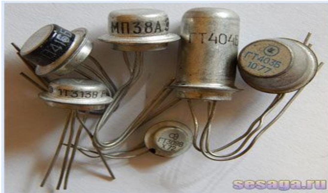
«М» - корпус транзистора холодносварный, буква «П» – «плоскостной», а цифры означают порядковый заводской номер транзистора. После заводского номера ставят буквы А, Б, В, Г и т.д., указывающие на разновидность транзистора в данной серии, например, МП42Б.
