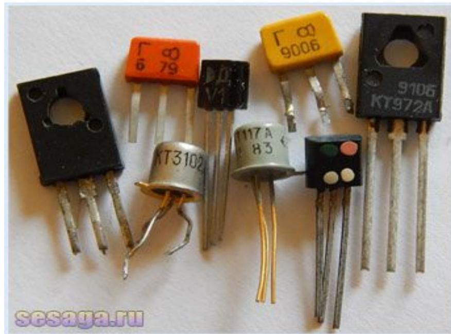
Основным методом изготовления современных транзисторов является **планарная технология**, а транзисторы, выполненные по этой технологии, называют **планарными**.
