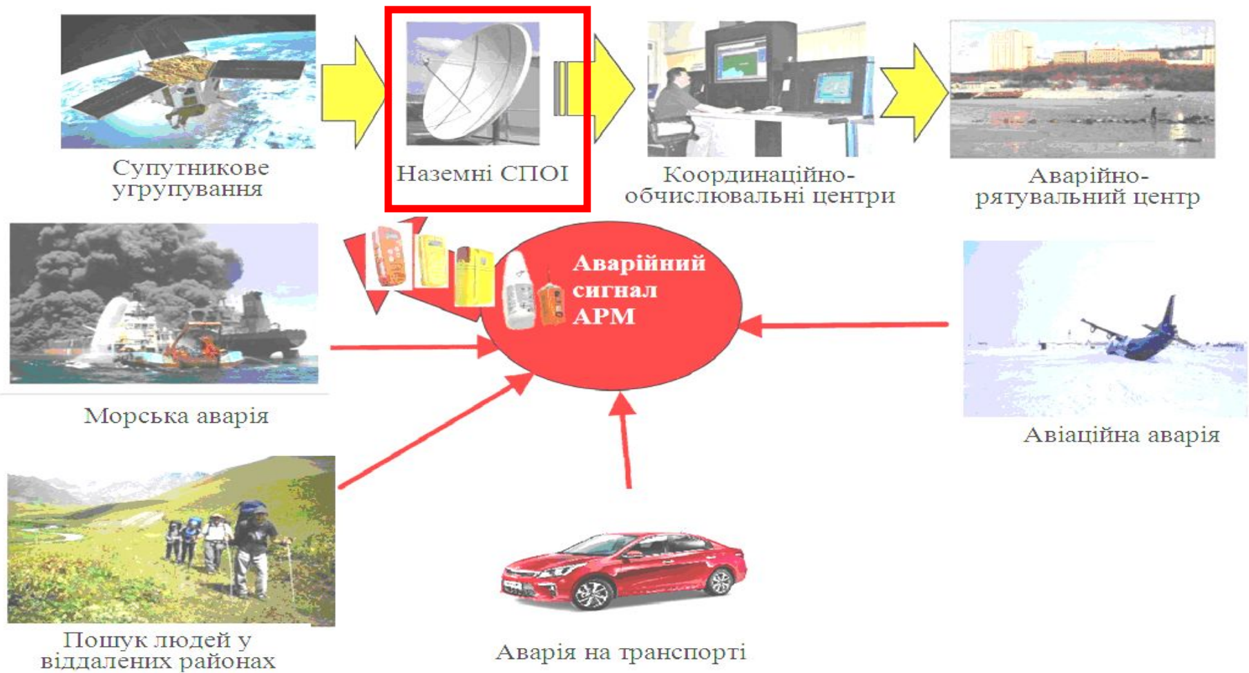
Рисунок 1. Структура міжнародної глобальної пошуково-рятувальної системи COSPAS/SARSAT - наземні станції приймання і обробки інформації від супутників (НСПОІ); - координаційно – обчислювальні центри системи (КОЦС);
