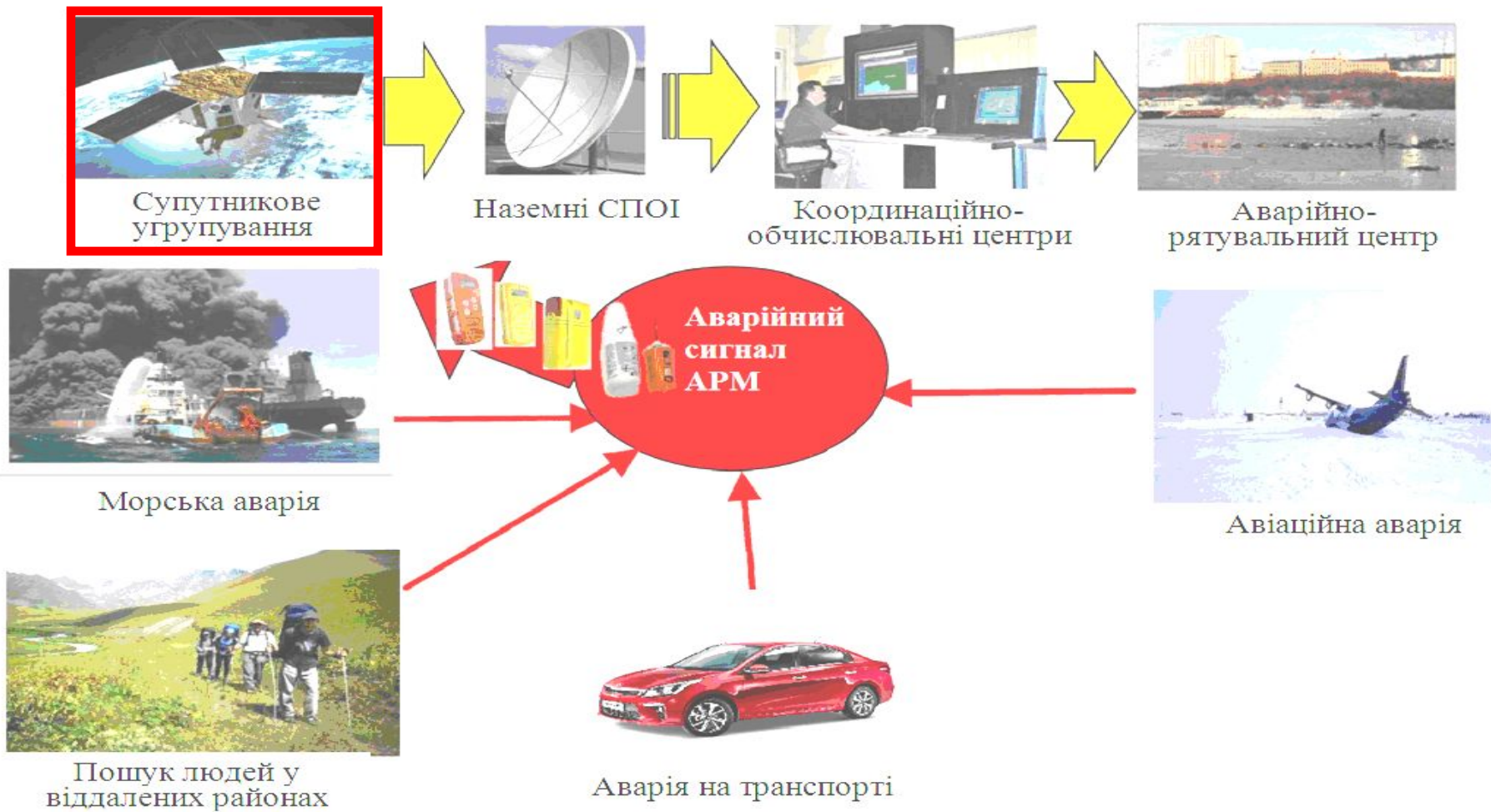
Рисунок 1. Структура міжнародної глобальної пошуково-рятувальної системи COSPAS/SARSAT - низькоорбітальні, середньо орбітальні і геостаціонарні супутники з встановлених на них ретрансляторами аварійних сигналів;
