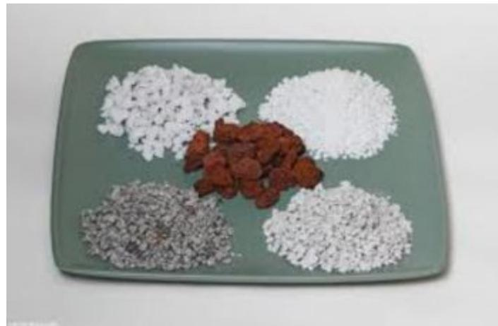
**Перлит** – вулканическая порода. При нагревании увеличивается в несколько раз, из-за чего процесс производства напоминает создание попкорна. Используется для теплоизоляции с середины прошлого века.
