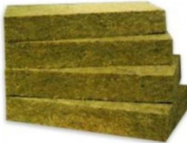
**Каменная вата** производится из горной породы диабаз путем расплавления и превращения жидкой массы в волокна. Такой материал на 99 % состоит из воздуха и только на 1 % из горной породы. Используется для утепления стен и других конструкций повсеместно.
