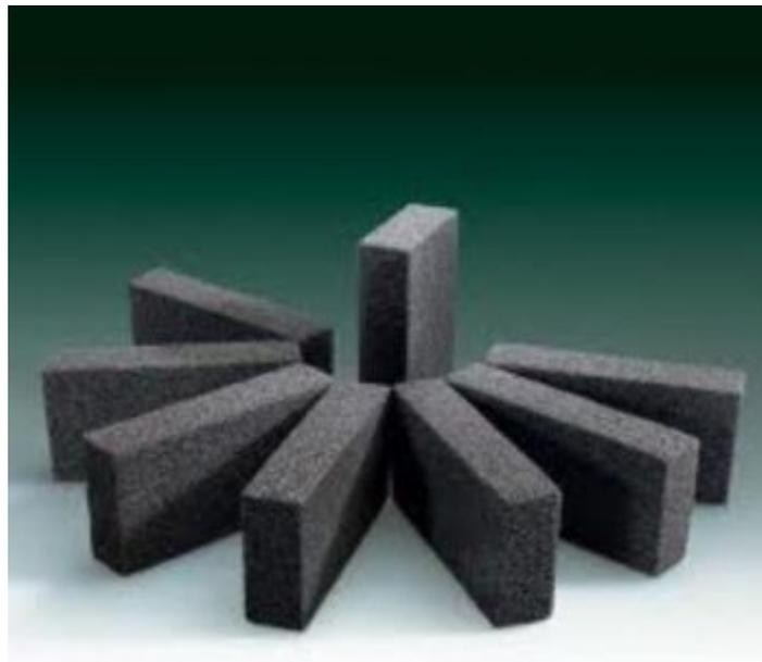
**Пеностекло (ячеистое стекло)** производится из стеклянного порошка путем его спекания с газообразователями. Воздух занимает 80 – 95 % материала.
