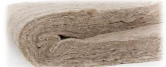
**Древесное волокно (целлюлозная вата)** на данный момент считается одним из самых известных органических теплоизоляционных материалов. Представляет собой древесный материал, измельченный до состояния ваты. Производится как в сыпучем виде, так и в плитах. Используется для задувания в полости стен.
