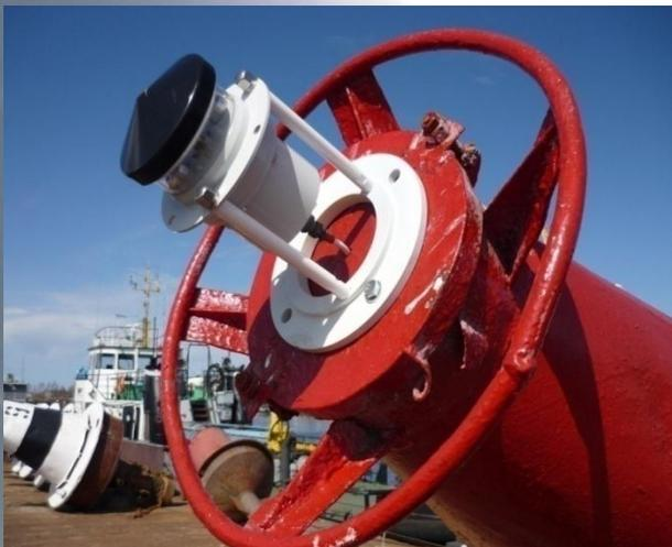
В 2009 г системой мониторинга знаков СНО оборудована Южная трасса. (15 знаков). В 2010 г. получен в рамках ФЦП ГЛОНАСС опытный образец системы мониторинга средств навигационного ограждения (СМ-СНО).
