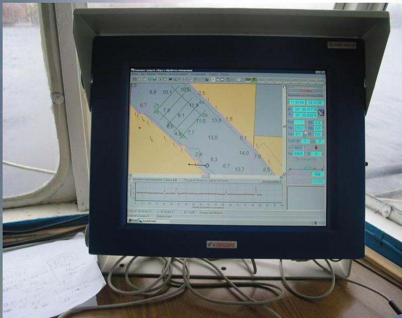
Все гидрографические работы на Волго-Балтийском водном пути проводятся с применением автоматизированных промерных комплексов (АПК). В настоящее время в ФБУ «Администрация «Волго-Балт» все 7 русловых изыскательских партий оснащены АПК.
