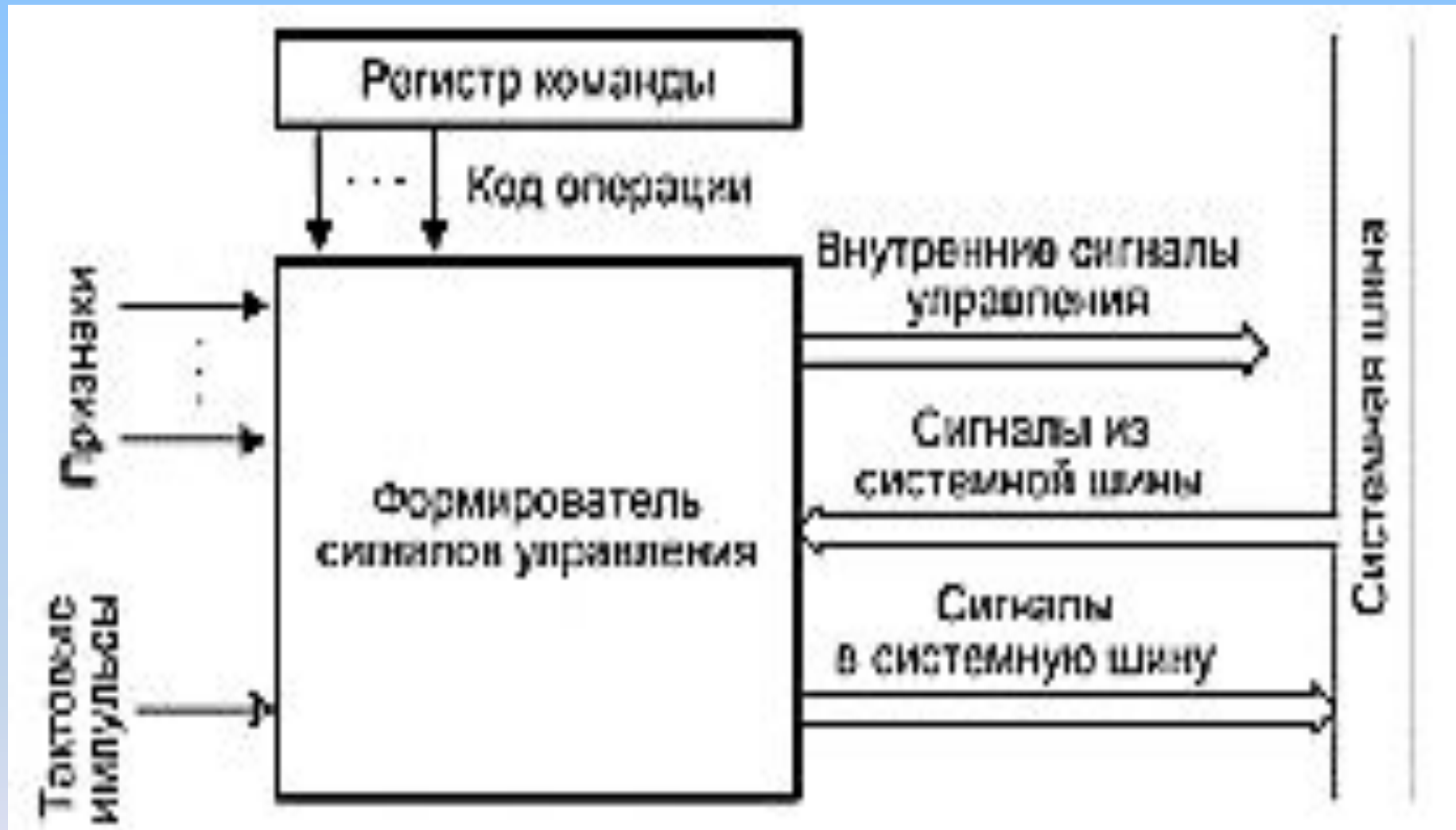
Рис. 2.2. Информационная модель микропрограммного автомата
