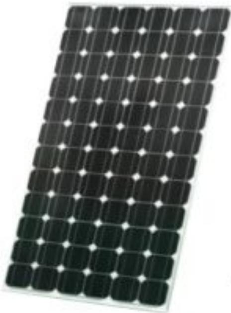
Монокристаллические кремниевые батареи представляют собой силиконовые ячейки, объединенные между собой. Для их изготовления используют максимально чистый кремний. После затвердевания готовый монокристалл разрезают на тонкие пластины толщиной 250-300 мкм, которые пронизывают сеткой из металлических электродов.
