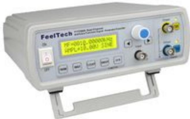
***Электронный генератор – это устройство, преобразующее электрическую энергию источника постоянного тока в энергию незатухающих электрических колебаний заданной формы и частоты.***
