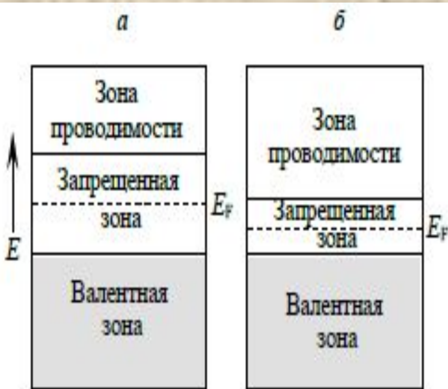
Схема энергетических зон в диэлектриках (а), полупроводниках (б)
