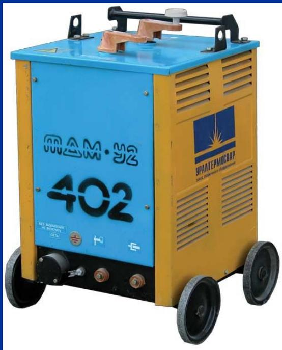
Сварочный трансформатор ТДМ-402 применяется для питания одного сварочного поста при ручной дуговой сварке, резке и наплавке металлов переменным током
