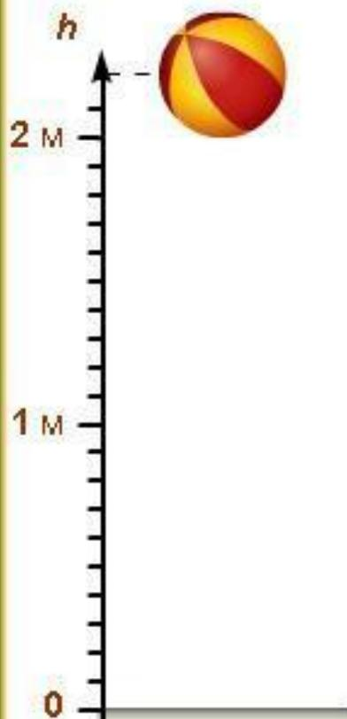
При движении тел может наблюдаться превращение одного вида механической энергии в другой: потенциальная энергия может превращаться в кинетическую и обратно; кинетическая энергия может превратиться в энергию упругой деформации тел. В отсутствие трения механическая энергия остается неизменной.
