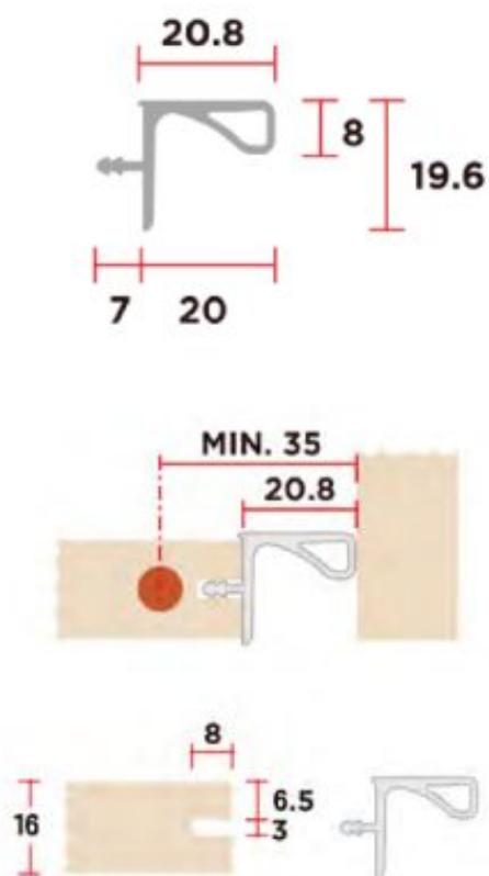
Монтажная схема для ЛДСП 18мм
