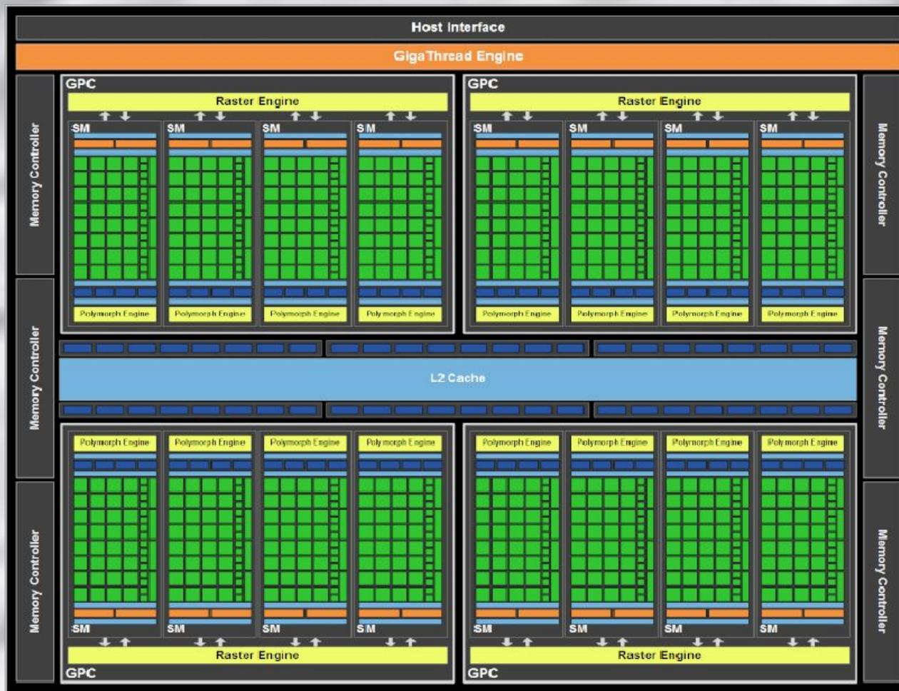
Каждый **SP** имеет **ALU** и блок операций с плав. точкой (**FPU**), *оба конвейерные*. **FPU** выдает результаты за **2 такта**.
