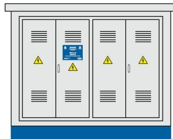
вид спереди КТП 6–15/0,4 кВ с бетонной кровлей
