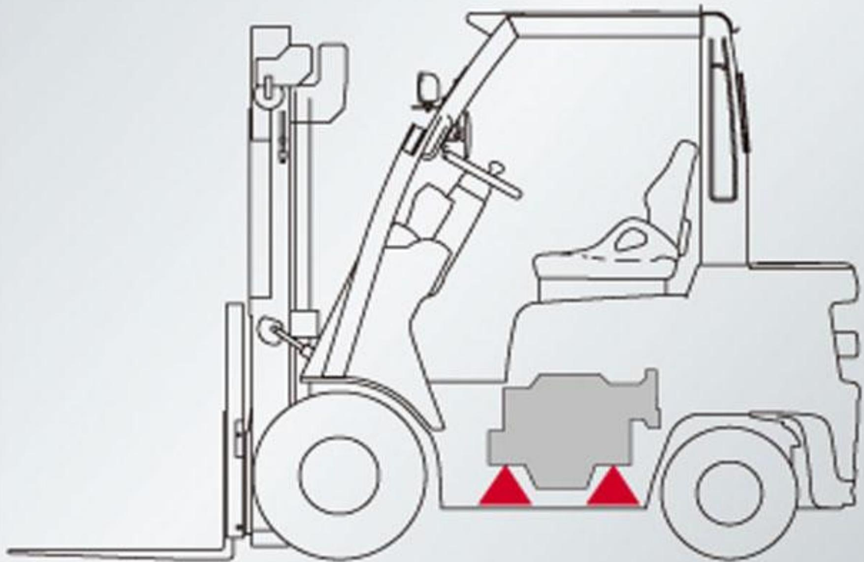
На переднем конце ходовой рамы установлен вертикальный грузоподъемник с рабочим органом, служащий для подъема груза, а на заднем укреплен противовес, обеспечивающий устойчивость движущегося погрузчика. Максимальная скорость движения автопогрузчика с грузом 6 -15 км/ч, без груза до 45 км/ч.
