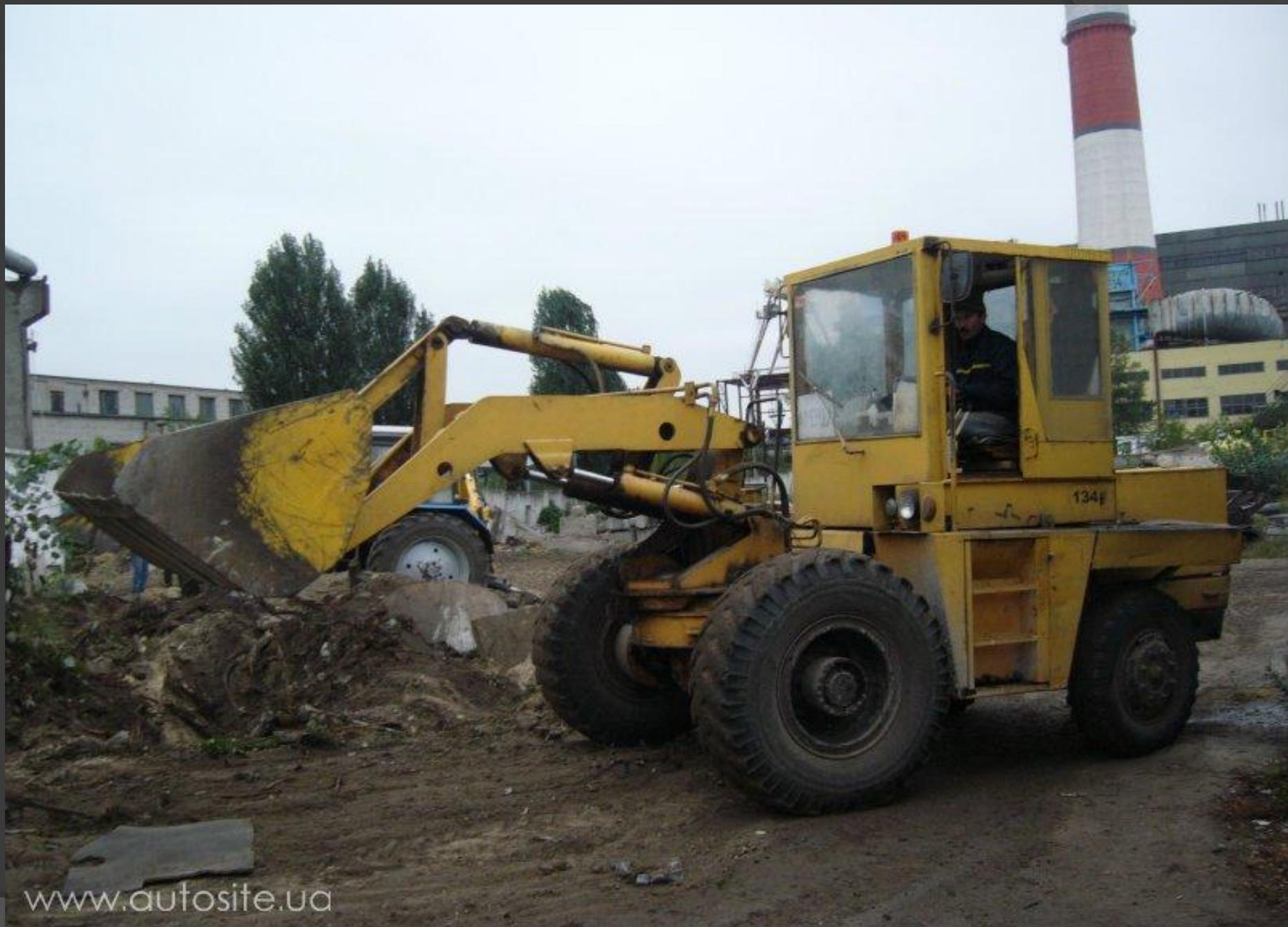
Рабочий цикл полуповоротного погрузчика отличается от рабочего цикла фронтального тем, что в нем отсутствуют операции на дополнительные развороты машины при разгрузке. (разгрузку можно производить с любой стороны машины).
