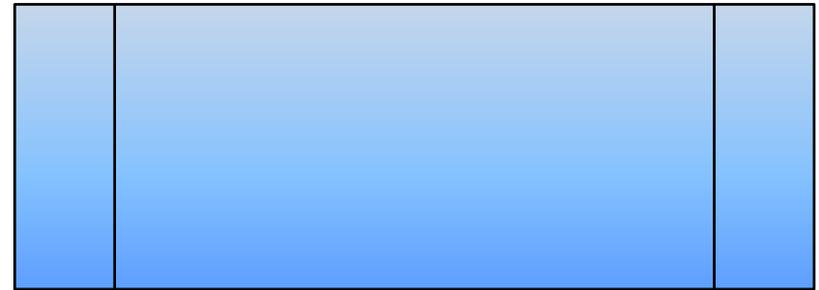
Символ отображает **предопределенный процесс**, состоящий из одной или нескольких операций или шагов программы, которые определены в другом месте (в подпрограмме, модуле). Например, в программировании — вызов процедуры или функции.
