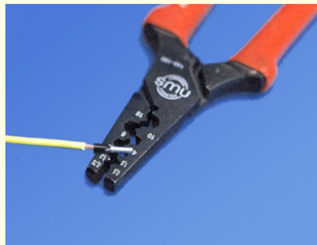
Плоскогубцы для оконцевания гибких медных жил оцинкованными трубочками
