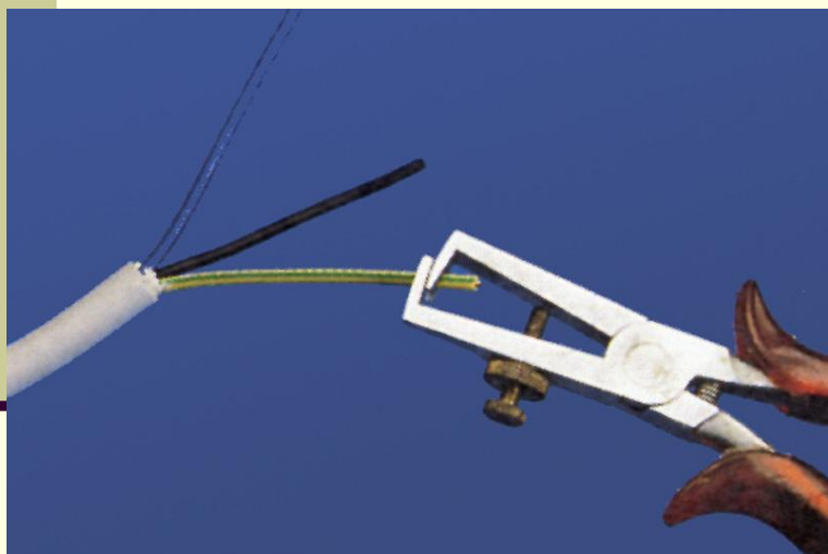
Снятие изоляции с проводов
