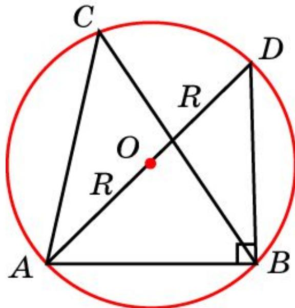
**Доказательство.** Опишем около треугольника  $ABC$  окружность с центром  $O$  и радиусом  $R$ . В треугольнике  $ABD$ , сторона  $AD$  которого проходит через  $O$ , углы  $C$  и  $D$  опираются на одну и ту же дугу и, следовательно, равны.  $\angle ABD = 90^\circ$ . Таким образом,  $\frac{AB}{\sin C} = \frac{AB}{\sin D} = AD = 2R$ . Аналогично имеют место и другие требуемые равенства.
