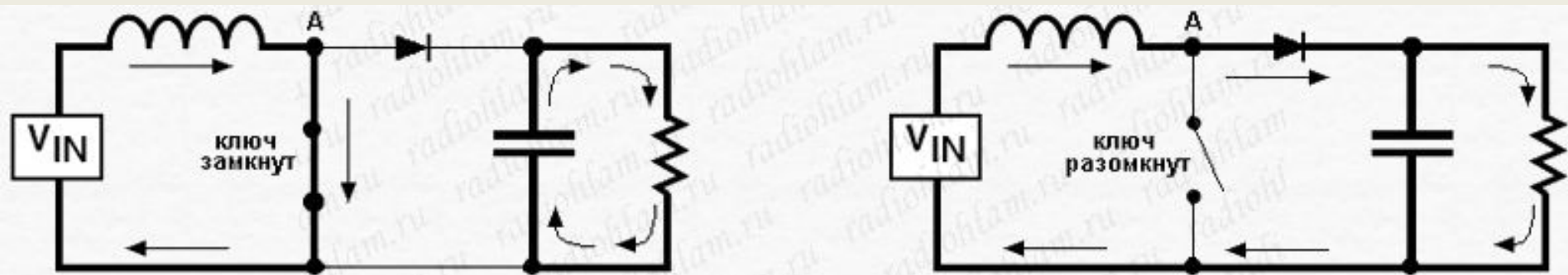
Рис. 8. Схема и режимы работы понижающего преобразователя
