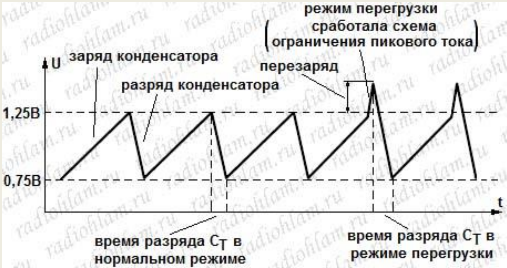
Рис. 13. Временная диаграмма заряда и разряда времязадающего конденсатора
