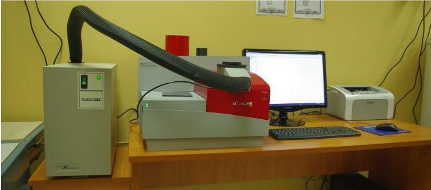
**Дифференциальный сканирующий калориметр DSC131 в комплекте с дополнительным оборудованием. SETARAM Instrumentation, Франция, 2013 г.**
