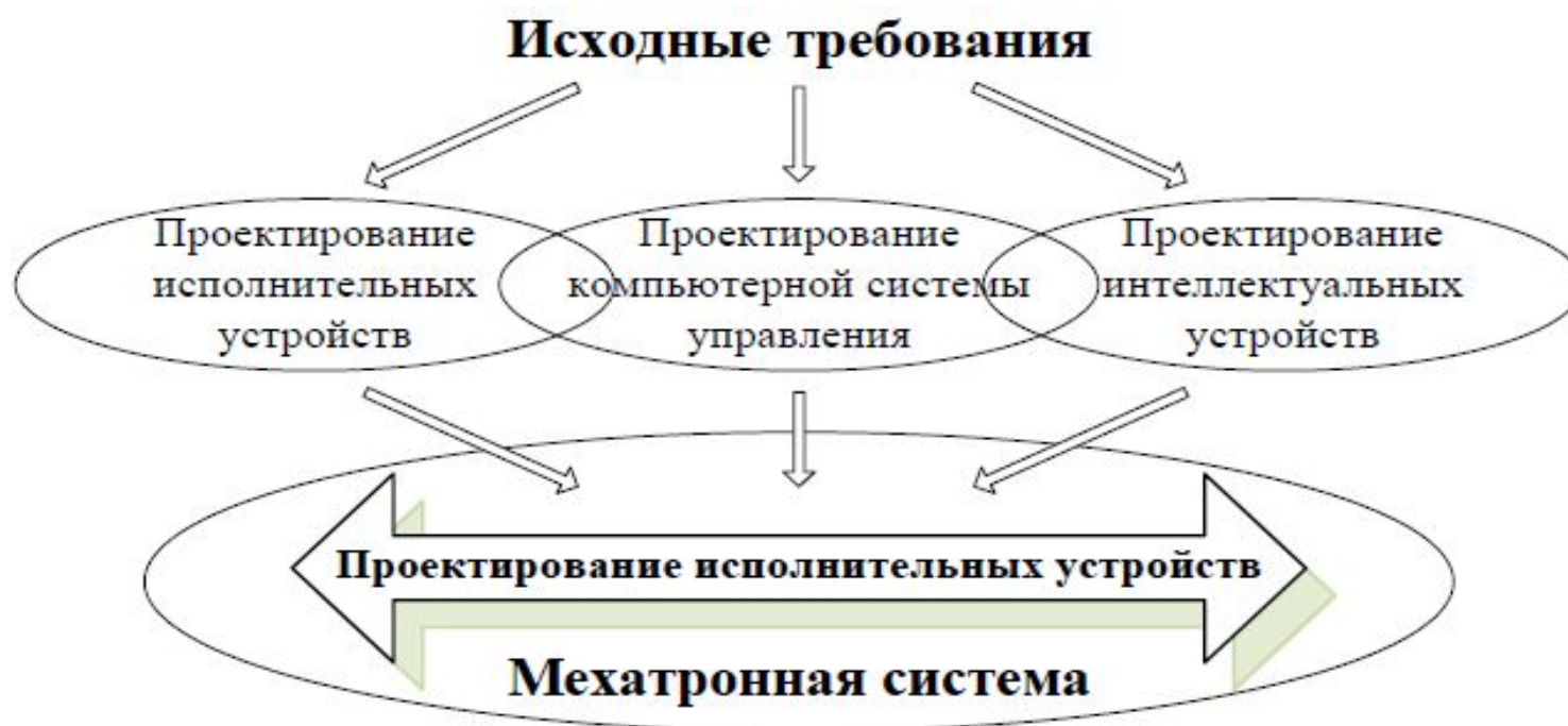
Рисунок 4.4 – Алгоритм параллельного проектирования мехатронных систем
