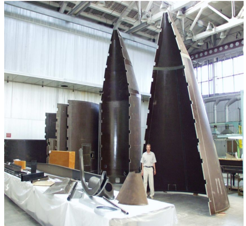
Элементы космической ракеты из углепластика
