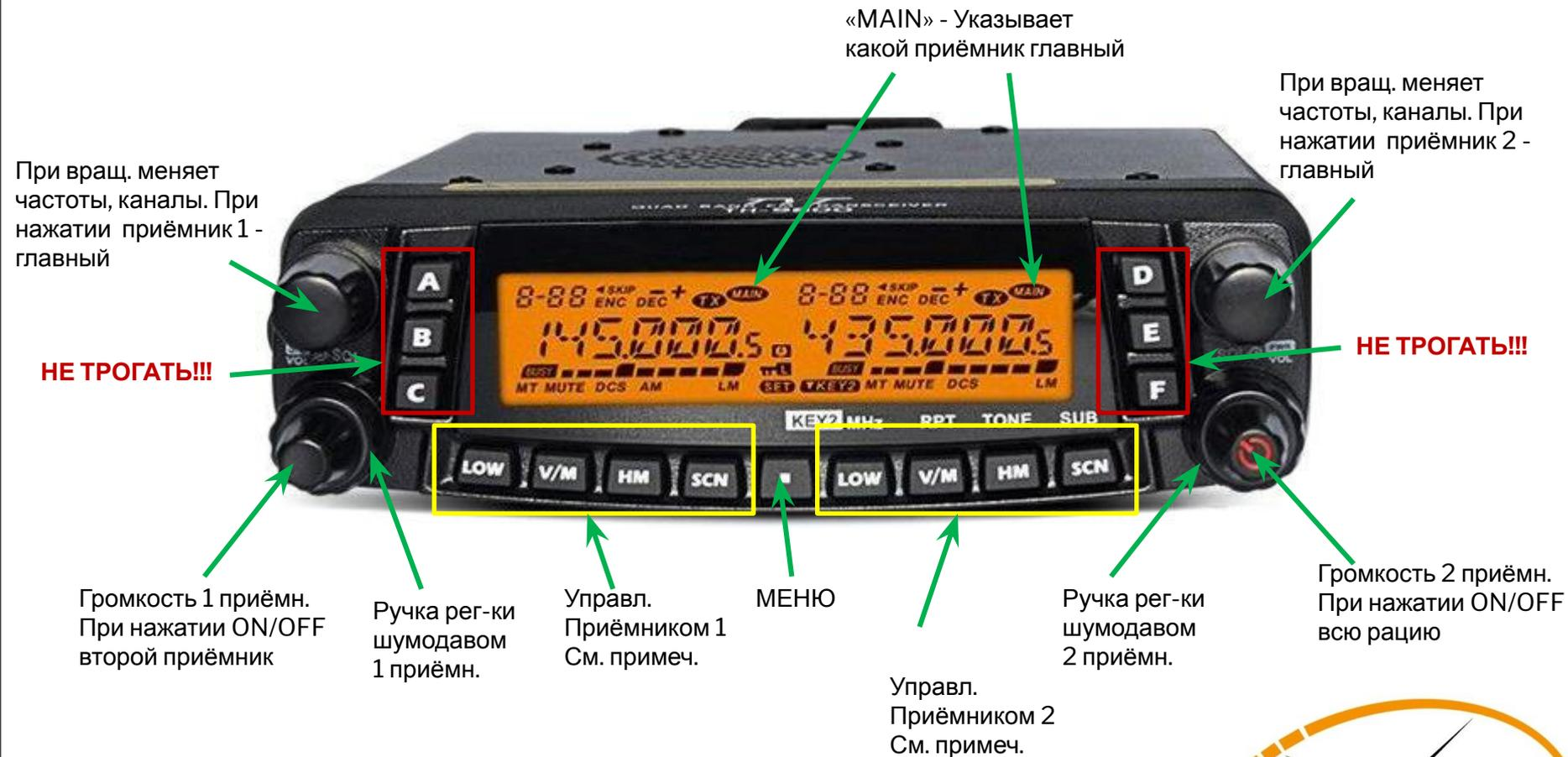
Примечания: LOW – регулировка мощности, V/M – переключение между частотным и канальным режимом, HM – домашняя станция (не нажимать), SCN - сканирование
