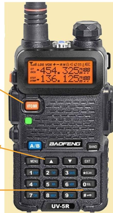
Перевод радиостанций Baofeng BF-A58, UV82 и т.п. из канального режима в прямой ввод частоты и обратно происходит через включение и удерживание кнопки **[MENU]**. При этом, удерживать кнопку **[MENU]** нужно до полного включения рации.
