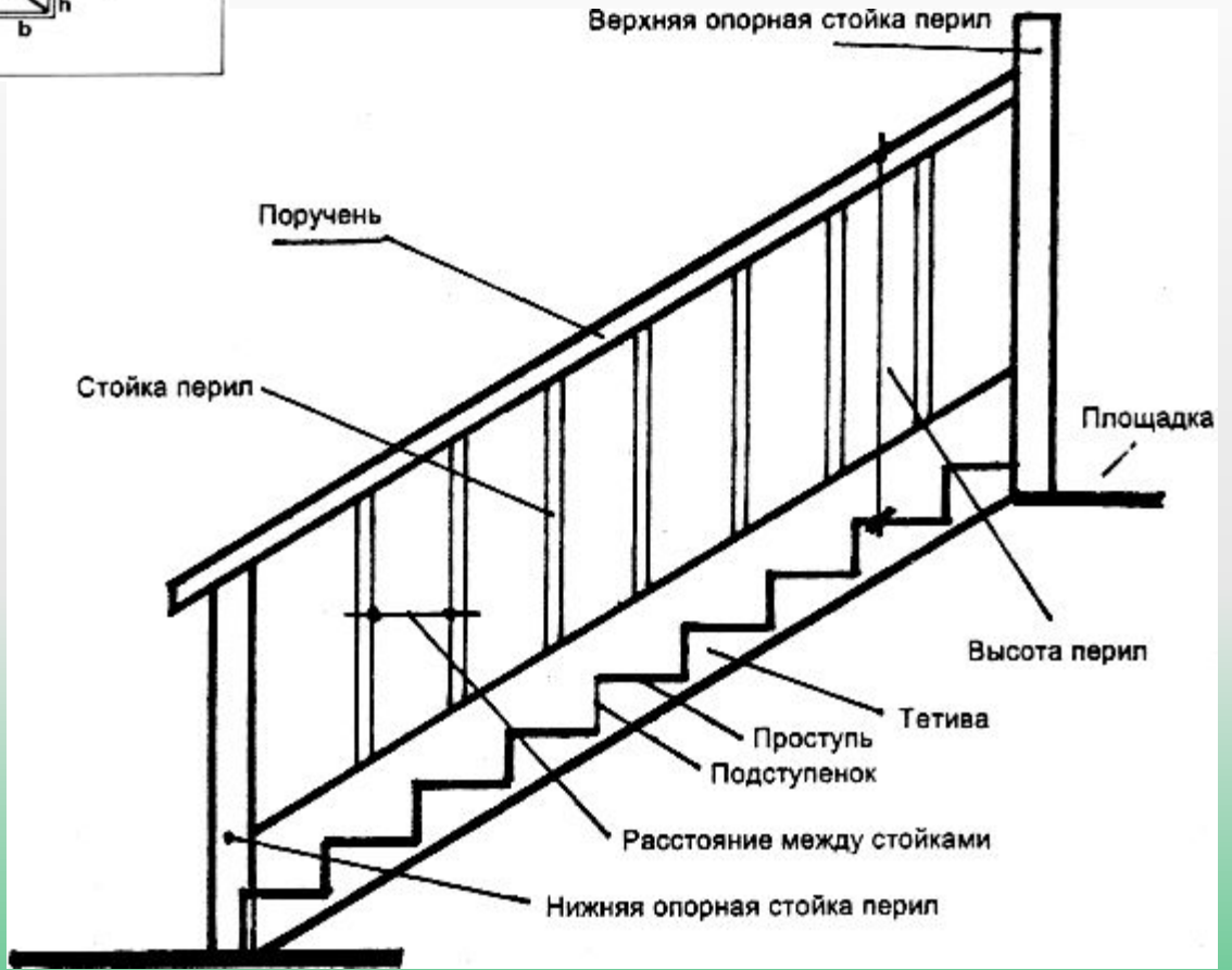
Рис.4. Схематическое изображение лестницы
