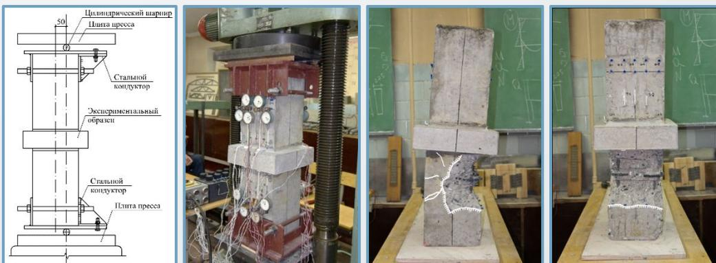
Испытания позволили разработать методики расчета прочности и деформативности штепсельных стыков плит с колоннами, необходимые для проектирования и внедрения сборной железобетонной несущей системы **УИКСС**.
