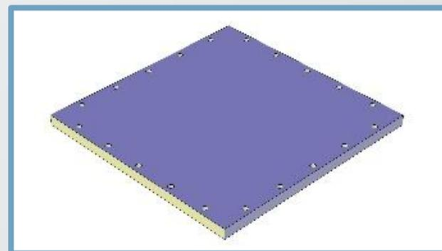
Толщина плит составляет 160 мм при сетке колонн 6×6 м
