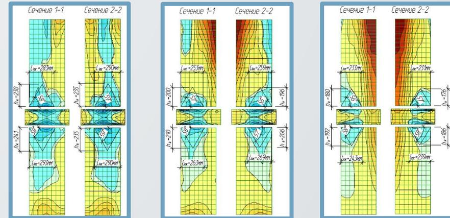
Возможные схемы разрушения
