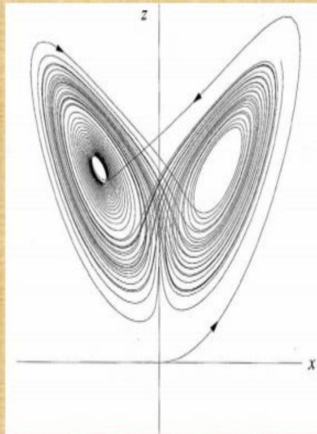
Система диссипативная: фазовый объем сжимается со скоростью  $\sigma + \beta + 1$ . Зафиксируем  $\sigma = 10$ ,  $\beta = 8/3$ . При  $\rho > 24.06$  возникает «странный аттрактор» с хаотическим движением.
