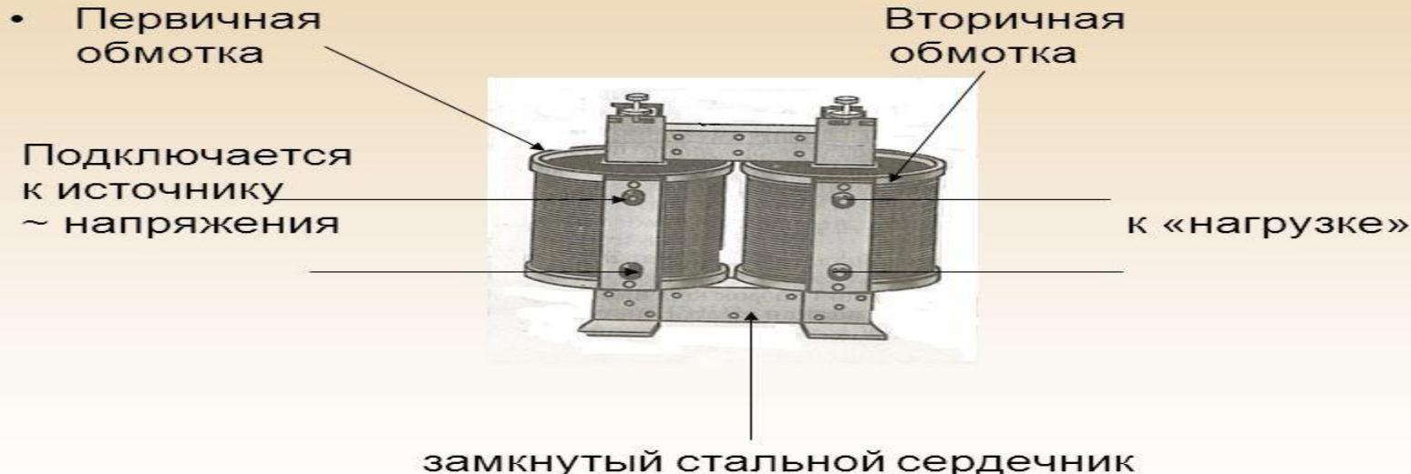
Одна из обмоток, называемая *первичной*, подключается к источнику переменного напряжения. Другая обмотка, к которой присоединяют нагрузку, т.е. приборы и устройства, потребляющие электроэнергию, называется *вторичной*.
