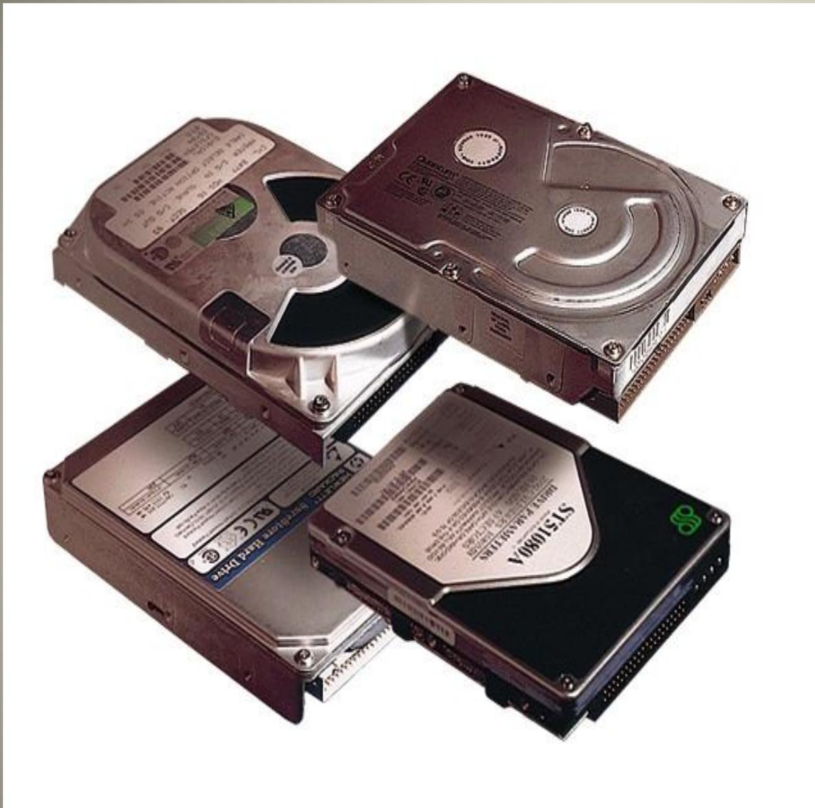
В отличие от «гибкого» диска (дискеты), информация в НЖМД записывается на жёсткие (алюминиевые или стеклянные) пластины, покрытые слоем ферромагнитного материала, чаще всего двуокиси хрома —
