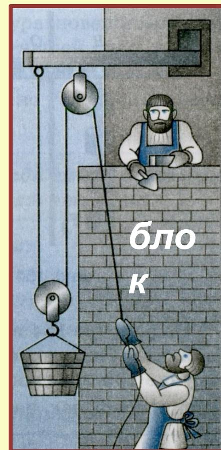
***Простые механизмы - это приспособления, служащие для преобразования силы.***
